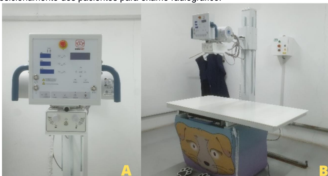
Figura 10 - A) Ampola e colimador do aparelho de raio-X; B) Mesa de posicionamento dos pacientes para exame radiográfico.
