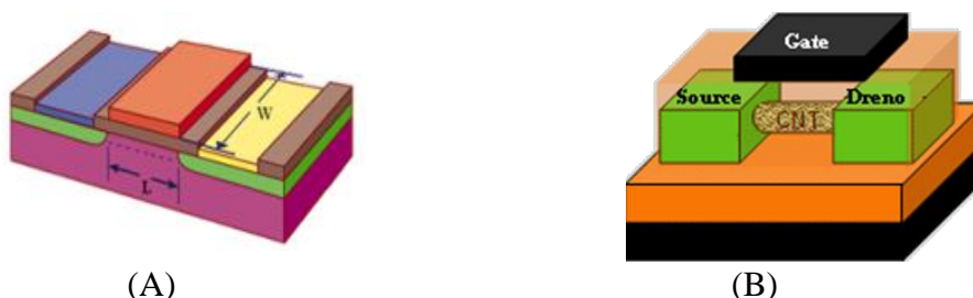
FIGURA 7 – Ilustração da Estrutura de um CMOS (A) e do CNTFET (B)
