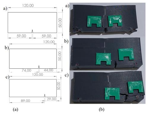
Figura 12 – (a) Dimensões das amostras, e (b) amostras impressas 3D.
