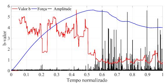
Figura 18 - Variação do valor-b, força e a amplitude dos eventos de EA para a amostra 1 sensor 2.
