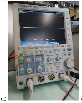
No menu do canal deixa-se o ganho de 1:1, escala linear e por fim a banda que é a frequência de corte (filtro do sinal), se queremos adquirir 50khz, devemos colocar pelo menos o dobro, utiliza-se o *dial button* indicado na Figura 9A abaixo:
