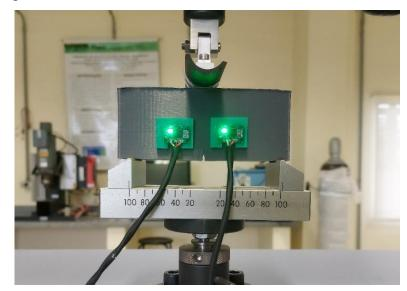
Figura 11 – Colagem dos sensores MEMS nas amostras.
