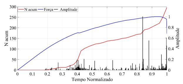
Figura 25 - Número acumulado de eventos, amplitude e a força registrada durante o ensaio para a amostra 3 e sensor 1.
