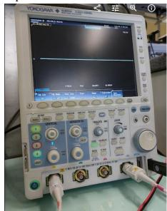
No botão auto o osciloscópio faz um auto setup, fica em 5 ms por divisão, em cada divisão mostrada no display tem 5 ms totalizando 10 divisões e com 50 ms.
