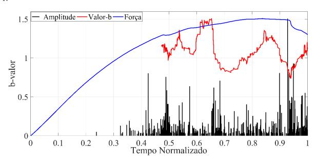
Figura 21 - Variação do valor-b, força e a amplitude dos eventos de EA para a amostra 2 sensor 1.
