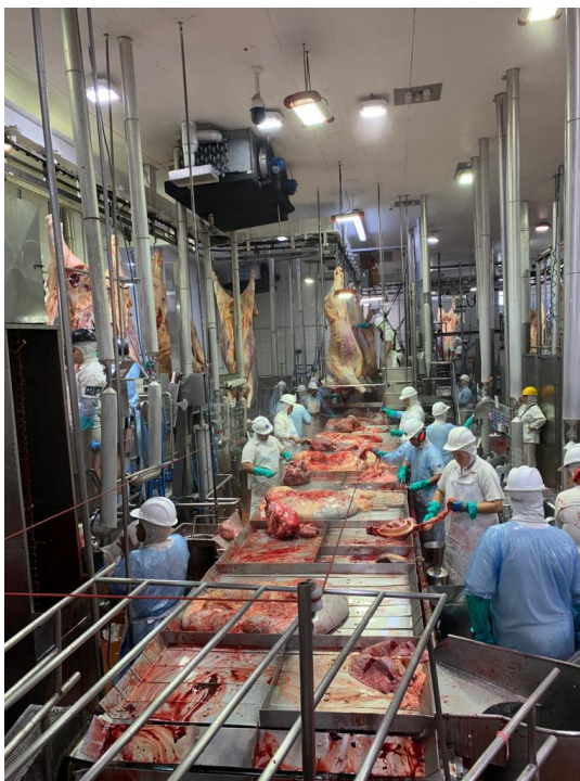
Figura 11 – Mesa rolante para inspeção de vísceras.
