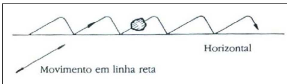
Figura 11 - Movimento linear de uma partícula sobre a superfície de peneiramento horizontal.
