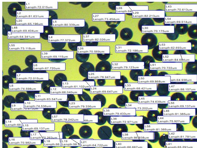
Figura 21 – Imagem mostrando a forma que foi coletado os dados para avaliação da distribuição granulométrica.
