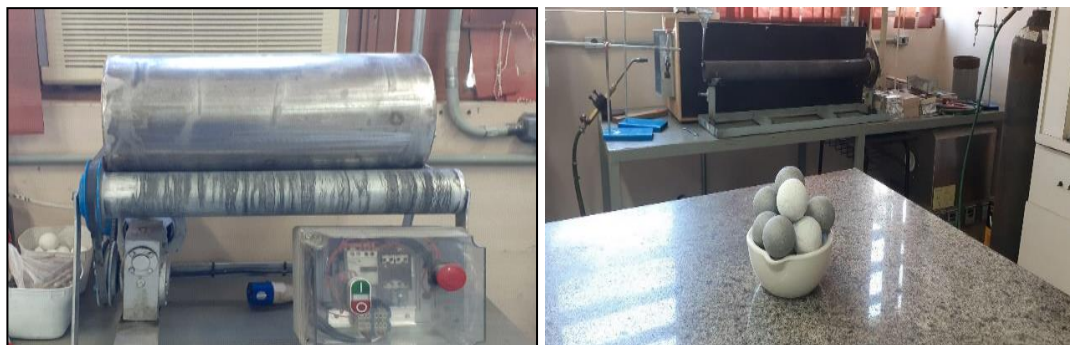
Figura 12 - (a) Equipamento de moinho de bolas e (b) bolas esféricas de Alumina.
