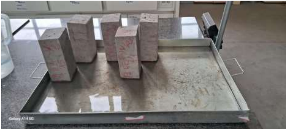
Figura 17-Ensaio Absorção de água por capilaridade
