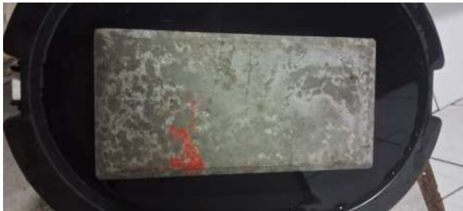
Figura 16- Ensaio de Absorção Total em andamento
