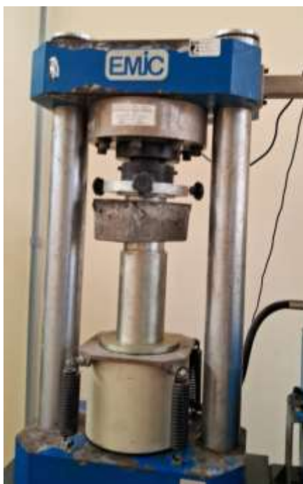
Figura 22- Ensaio Resistência à Compressão Axial dos Pavers
