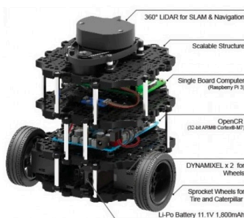
Figura 7 – Estrutura física do TurtleBot3
