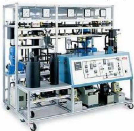
Figura 7 – Planta de extração por fluido supercrítico
