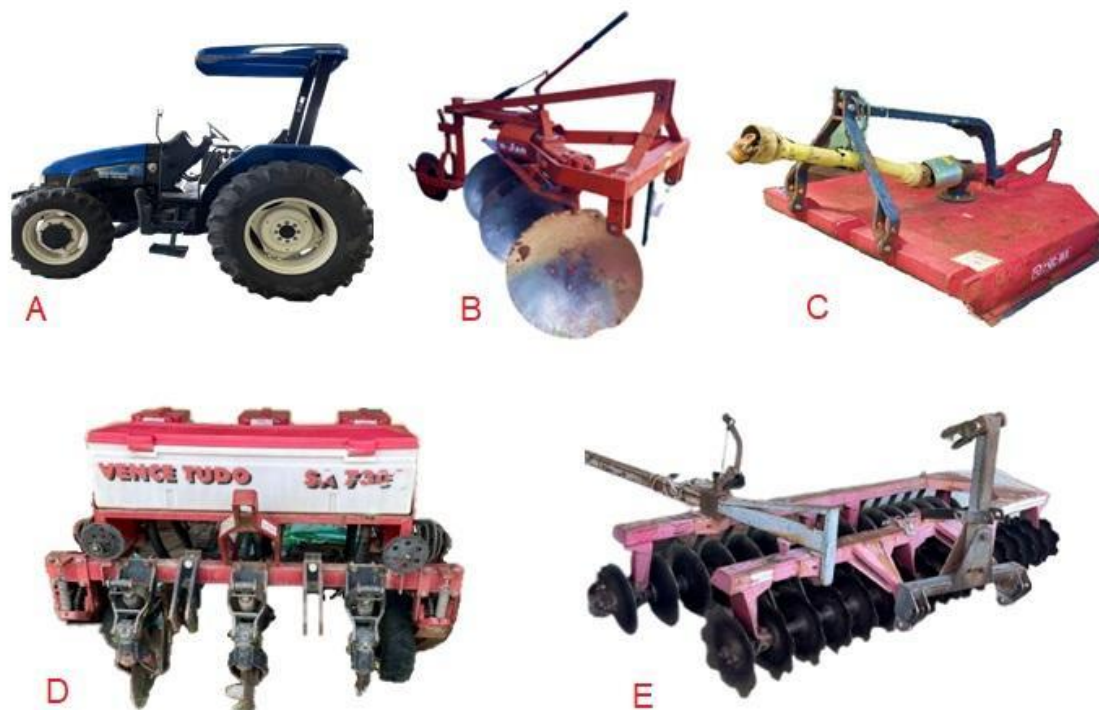
Figura 2 - Trator agrícola (a); arado de discos (b); roçadeira (c); semeadora adubadora (d) grade niveladora (e).
