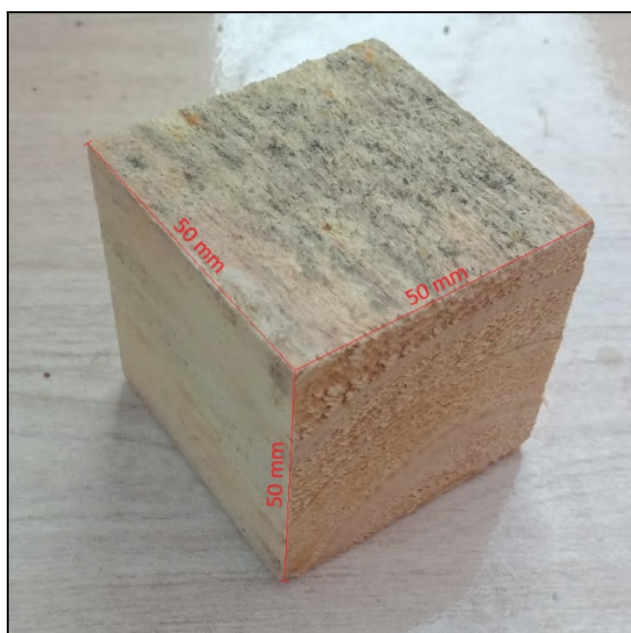
Figura 26 - Corpo-de-prova para determinação da umidade da madeira
