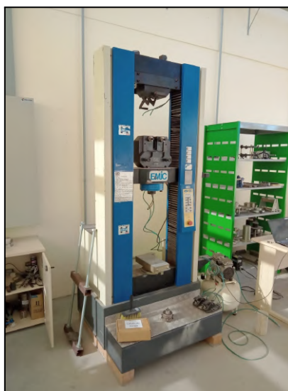
Figura 7 - Máquina modelo EMIC 23-200, marca INSTRON/EMIC com capacidade de carregamento de 200kN
