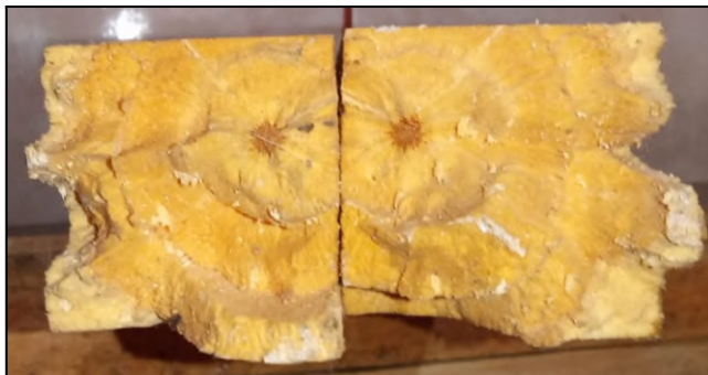
Figura 38 - Amostra F10 com presença de medula após o rompimento
