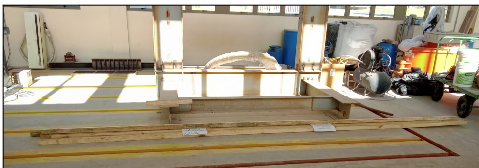
Figura 27 - Caibros de 5,5 m de comprimento com 5 x 5 cm de seção
