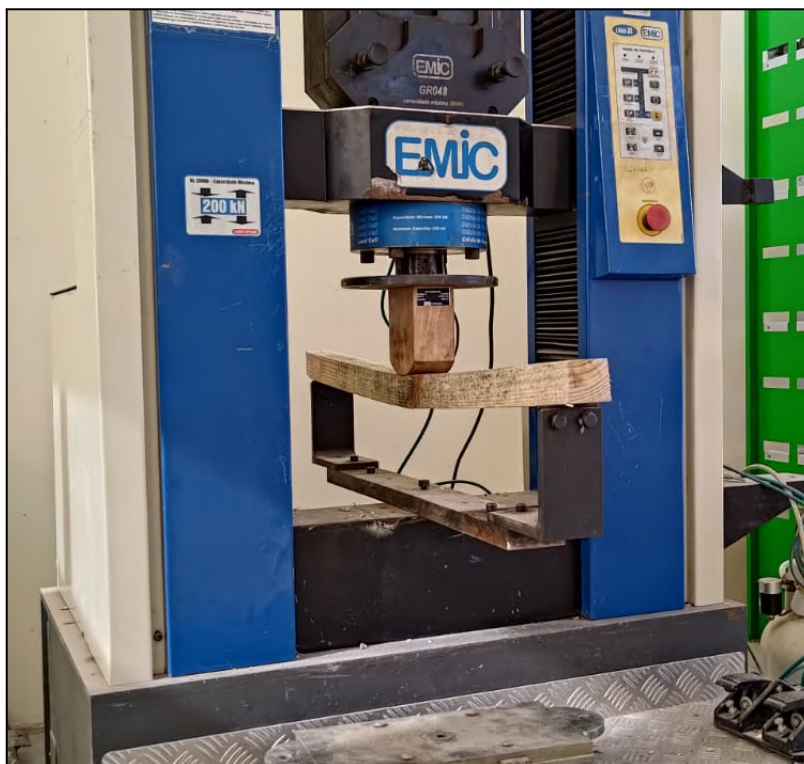
Figura 37 - Ensaio de flexão em três pontos no equipamento INSTRON/EMIC
