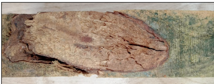
Figura 29 - Nó da amostra F40 com diâmetro igual a espessura da borda
