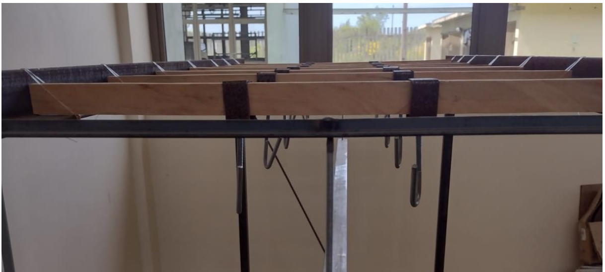
Figura 17 – Ganchos posicionados no corpo de prova
