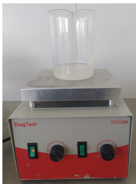
Figura 23 – Processo de solubilização da goma xantana em agitador magnético
