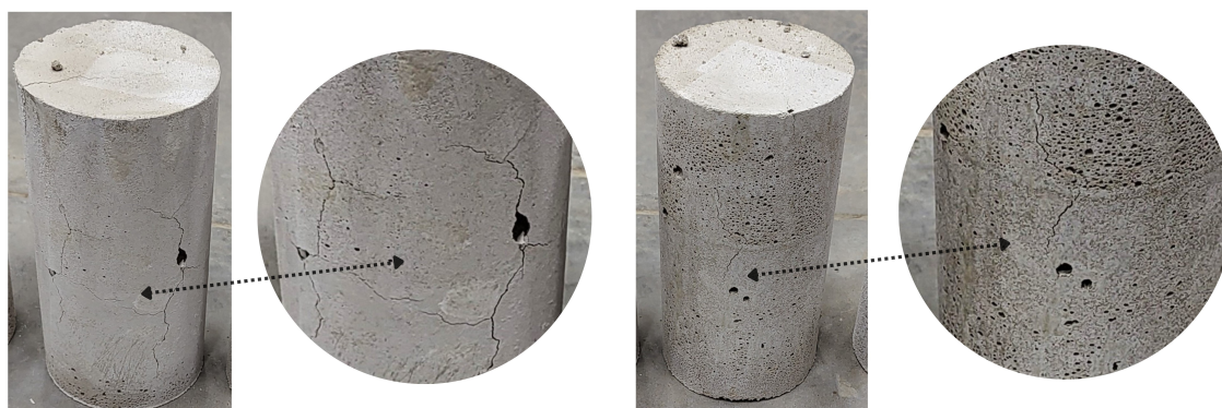
Figura 63 – Fissuração dos corpos de prova 1200 XG-2 600°C
