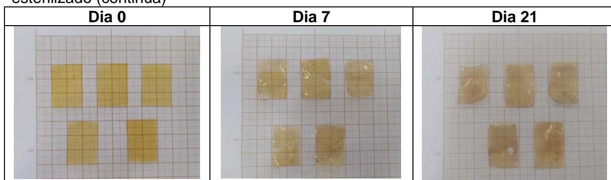
Quadro 12 - Blendas de ágar e quitosana antes e depois da degradação em solo esterilizado (continua)
