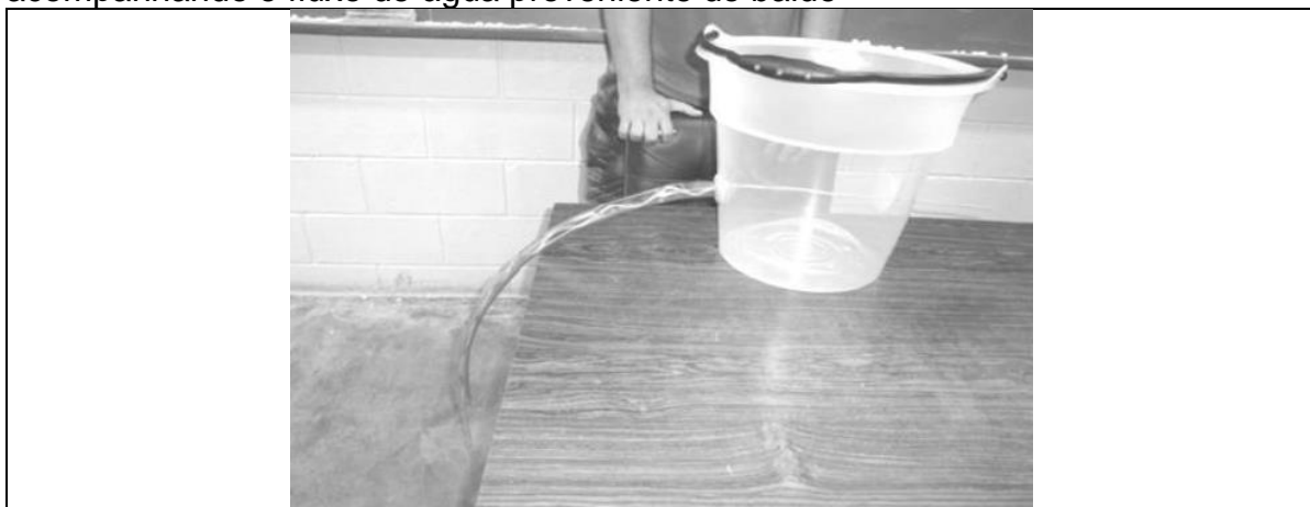
Figura 25: Princípio de funcionamento da fibra óptica - representação do laser acompanhando o fluxo de água proveniente do balde
