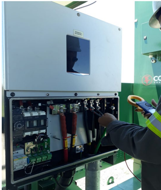
Figura 18 – Teste quente I X V – Tensão e corrente.
