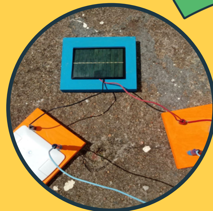
Circuito elétrico com a placa fotovoltaica
