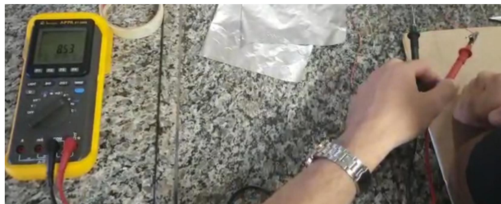
Figura 22 - Medição da capacitância em aumento ao exercer uma pressão e diminuir a distância entre as placas.
