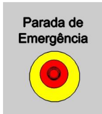
Figura 27 – Botão de parada de emergência
