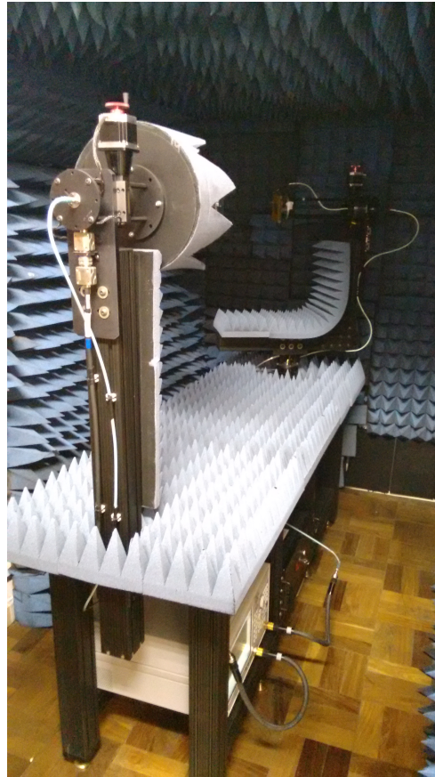
Figura 36: Antena sendo validada em campo próximo em um NFS.
