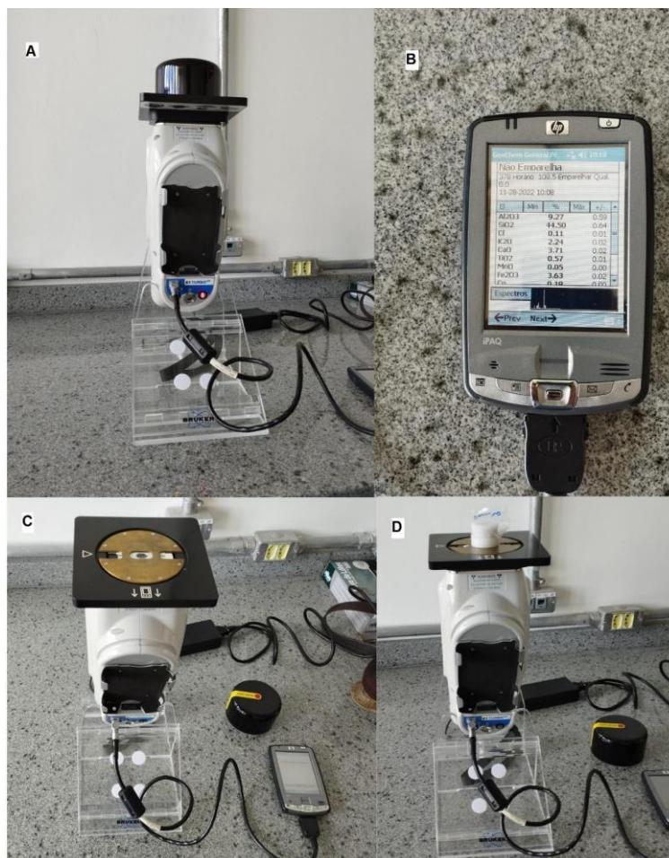
Figura 9. Espectômetro de fluorescência por raios-X Brucker modelo S1 Turbo SD-LE de propriedade do LATRAM – UNIPAMPA, onde, em (A), vê-se o espectômetro em funcionamento; em (B), o painel eletrônico com as informações de varredura; em (C), o detalhe para o leitor no topo do aparelho; por fim, em (D), uma das amostras granodioríticas sob análise.
