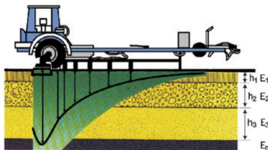
Figura 2 - Esquema de um deflectômetro de impacto
