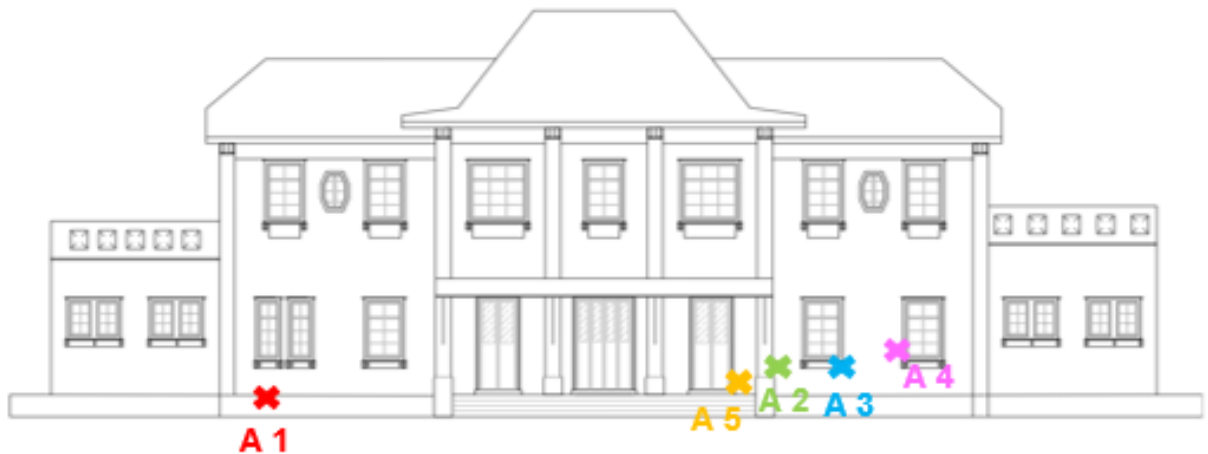
Figura 8 – Fachada frontal da estação com indicação dos pontos de extração das amostras
