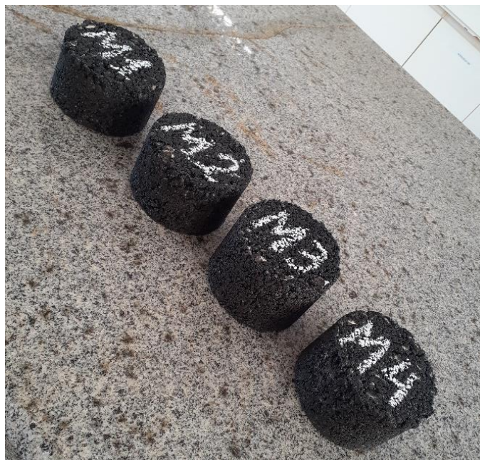
Figura 12 - Amostras desmoldadas e identificadas.
