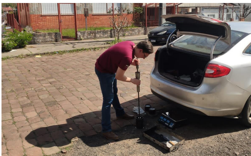
Figura 10 - Processo de compactação Marshall em campo.
