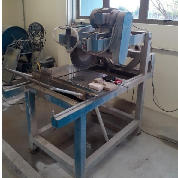
Figura 16 - Serra de mesa utilizada para o fatiamento das amostras.
