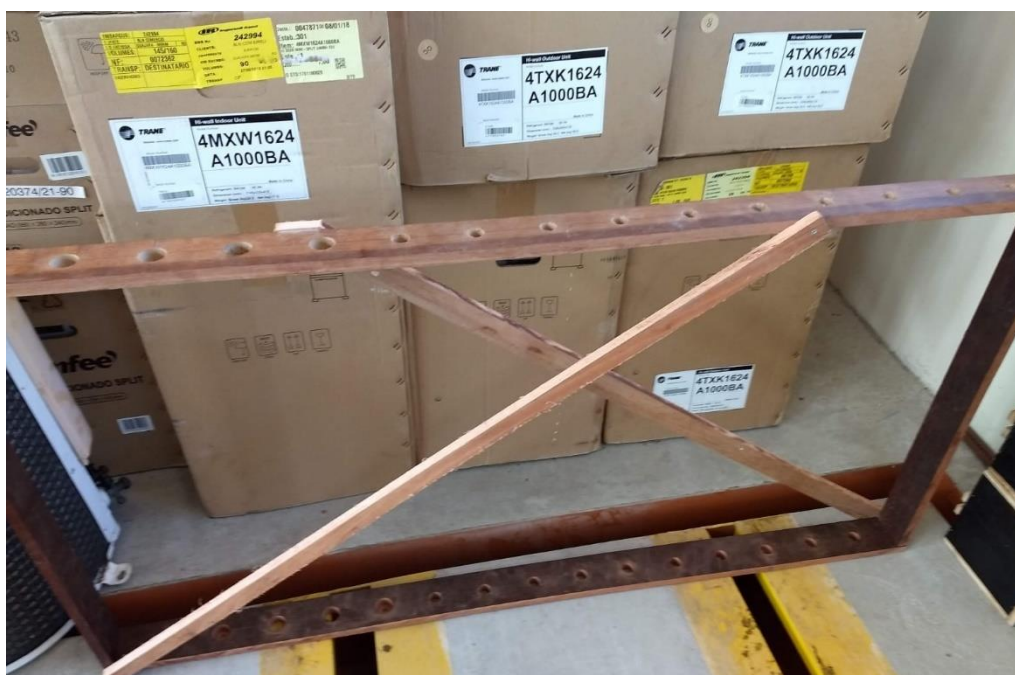
Figura 13 - Estrutura para moldagem da ancoragem nos corpos de prova
