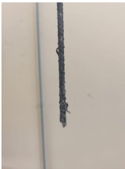
Figura 17 - Ruptura do Corpo de Prova de diâmetro de 8 mm
