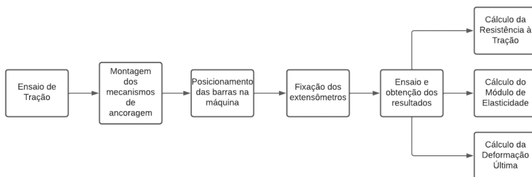
Figura 9 - Procedimento Experimental para a Determinação da Resistência à Tração, Módulo de Elasticidade e Deformação Última
