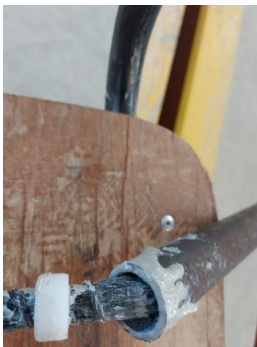
Figura 21 - Ruptura do CP5 de diâmetro de 12 mm
