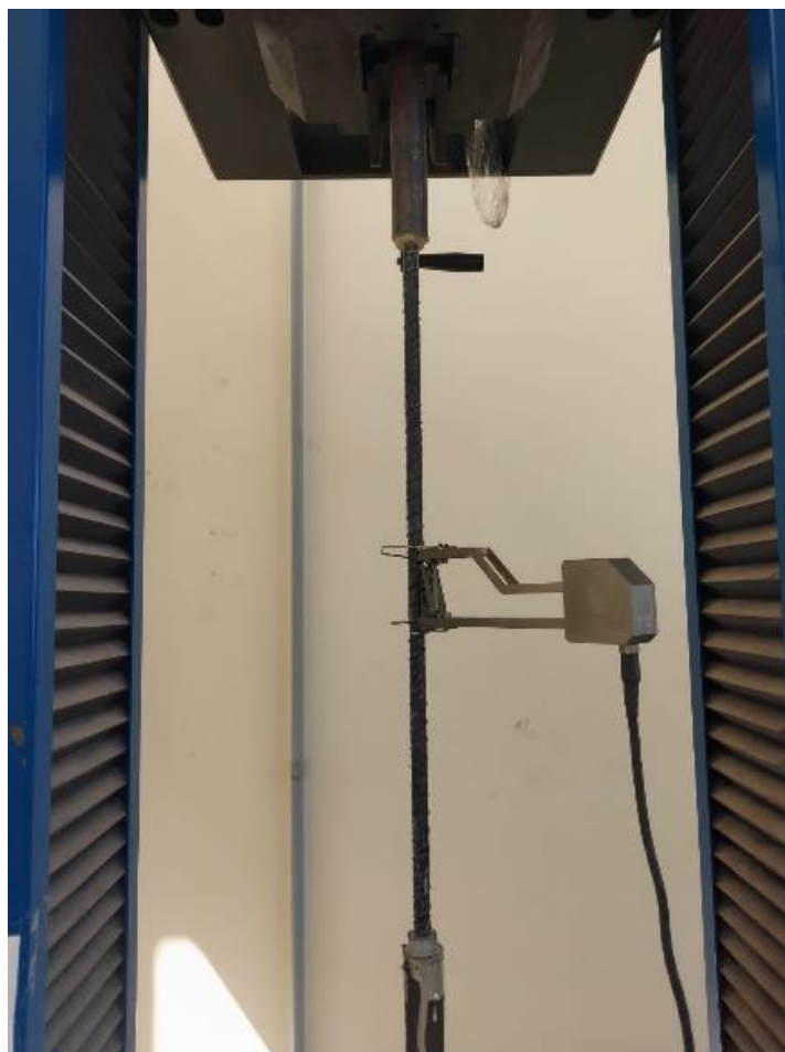
Figura 15 - Barra ancorada e com clip gauge presa à máquina de ensaio
