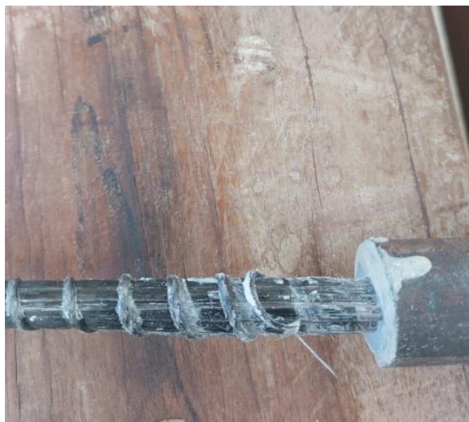
Figura 19 - Ruptura do corpo de prova de diâmetro de 10 mm
