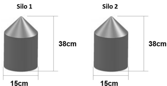
Figura 2 - Dimensões dos protótipos silos verticais.
