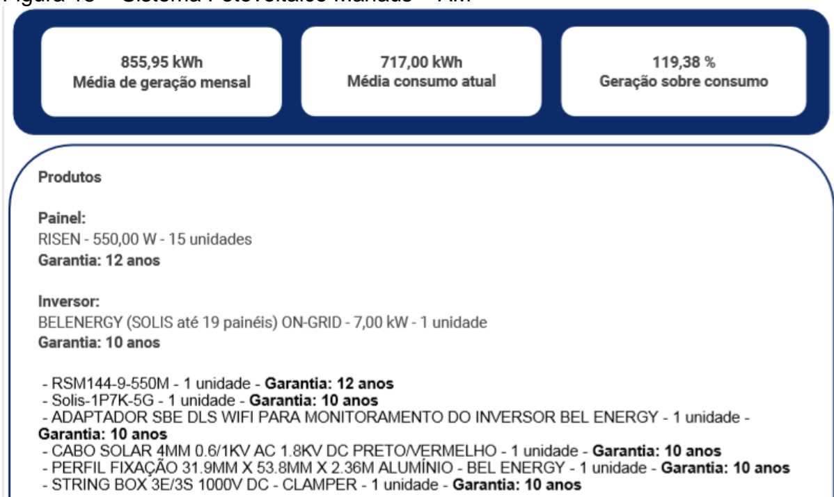
Figura 18 – Sistema Fotovoltaico Manaus – AM
