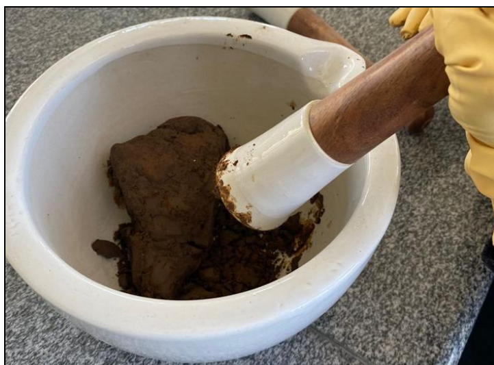
Figura 10. Destorroamento do lodo de estação de tratamento de água (LETA).
