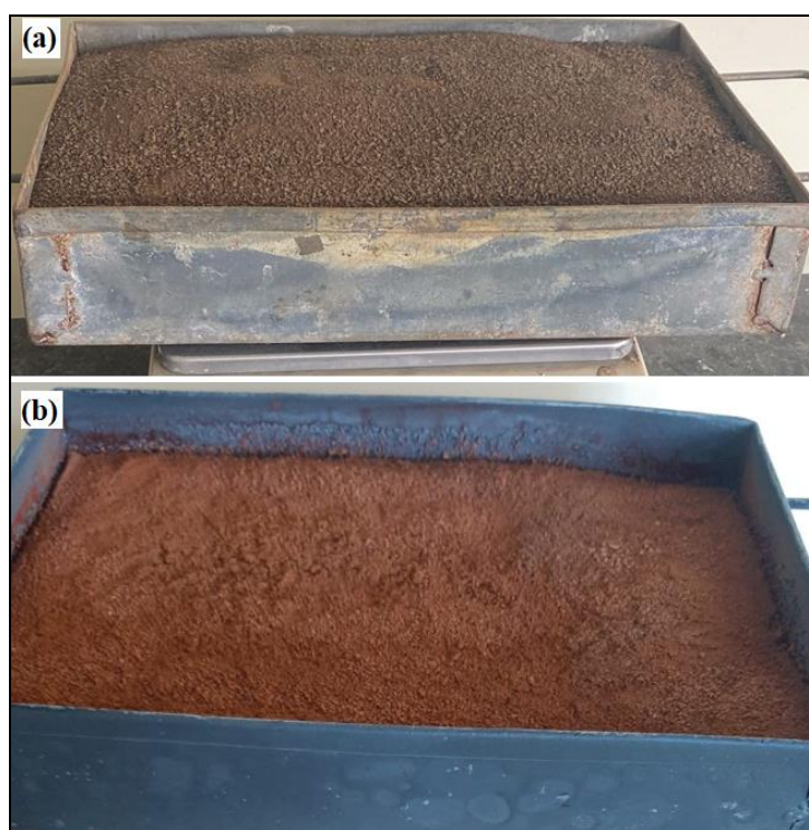
Figura 12. (a) LETA seco à 105°C; (b) LETA calcinado à 1000°C.
