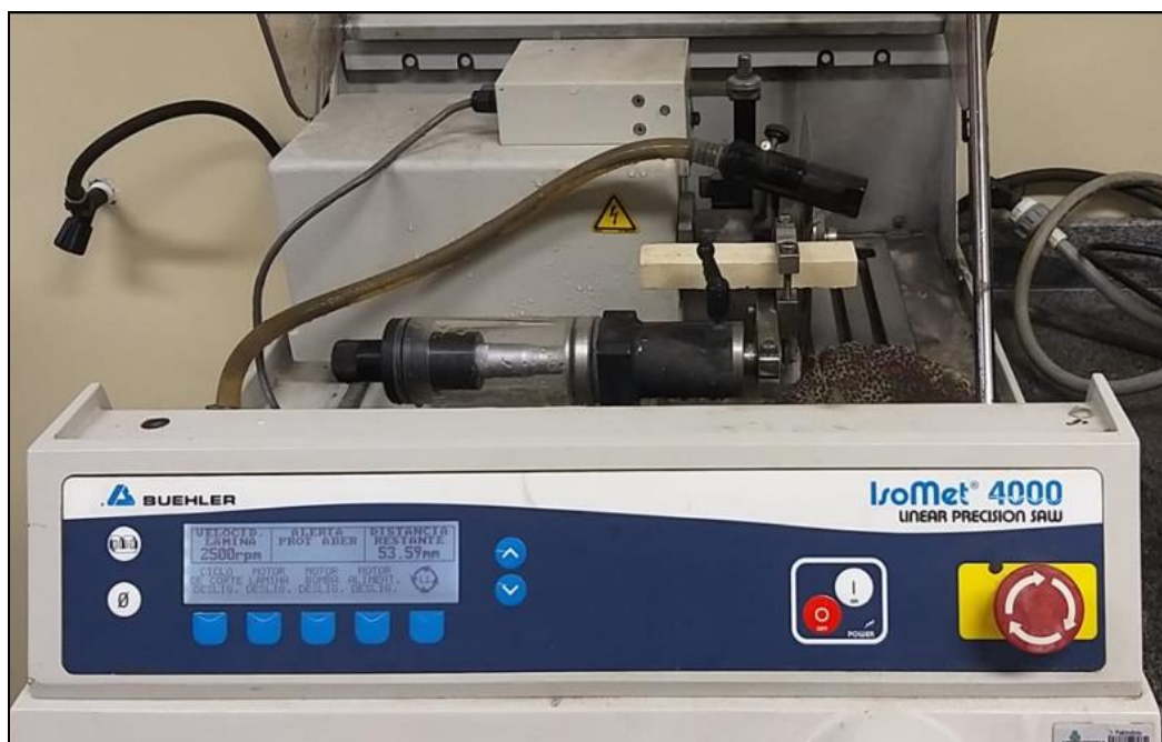
Figura 22. CP sendo cortado com auxílio da cortadora linear de precisão IsoMet 4000.
