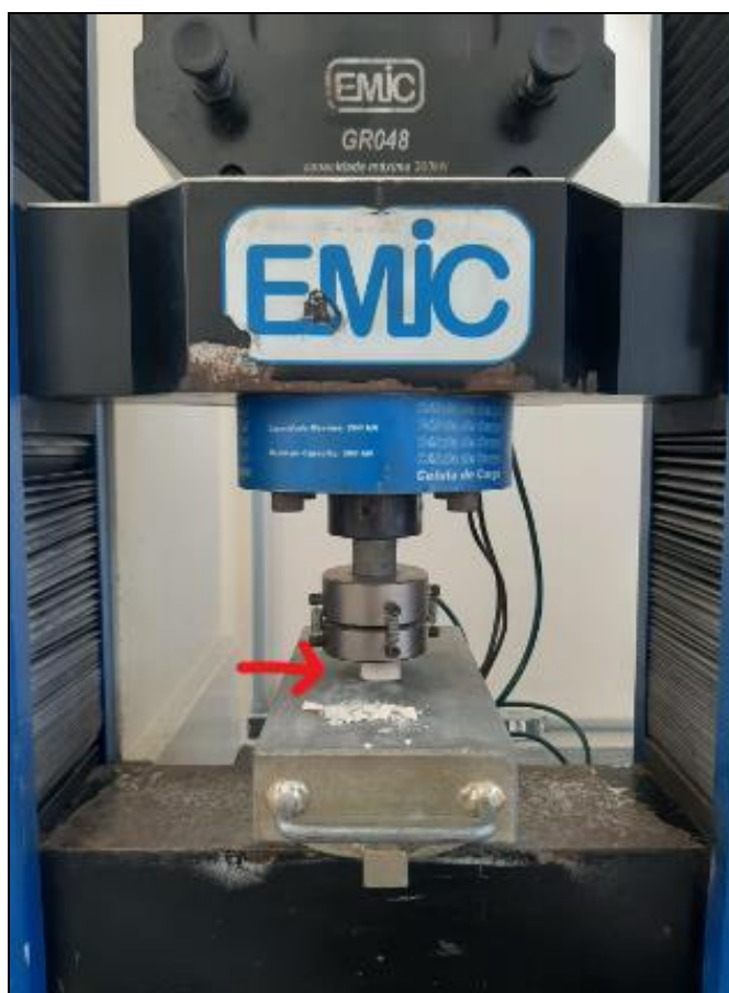
Figura 24. Execução do ensaio de resistência à compressão.
