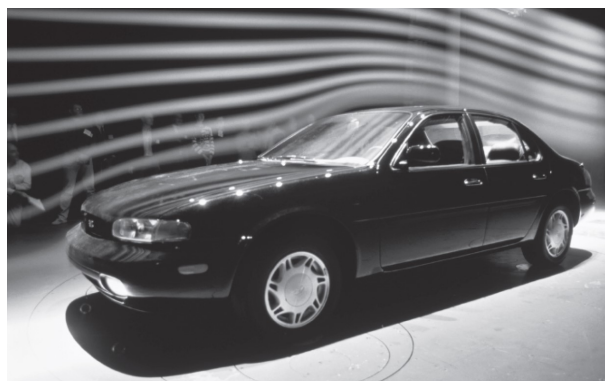
Figura 4 – Linhas de emissão sobre um automóvel em um túnel de vento
