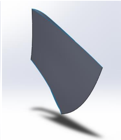
Figura 37 - Desenho da pá da turbina Francis
