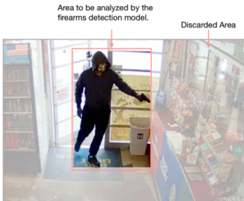
Figura 18 – Segmentação e descarte de áreas desnecessárias.
