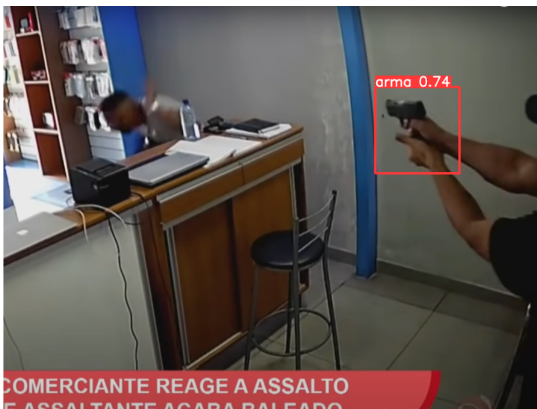
Figura 22 – Exemplo de identificação de arma pela RN.
