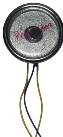
Figura 39 – Sensor GY-MAX9814 conectado ao estetoscópio.
