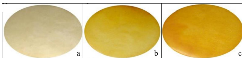
Figura 3 – Membranas de quitosana: a) pura; b) com adição de 0,5 % de extrato; c) com adição de 1,0 % de extrato.
