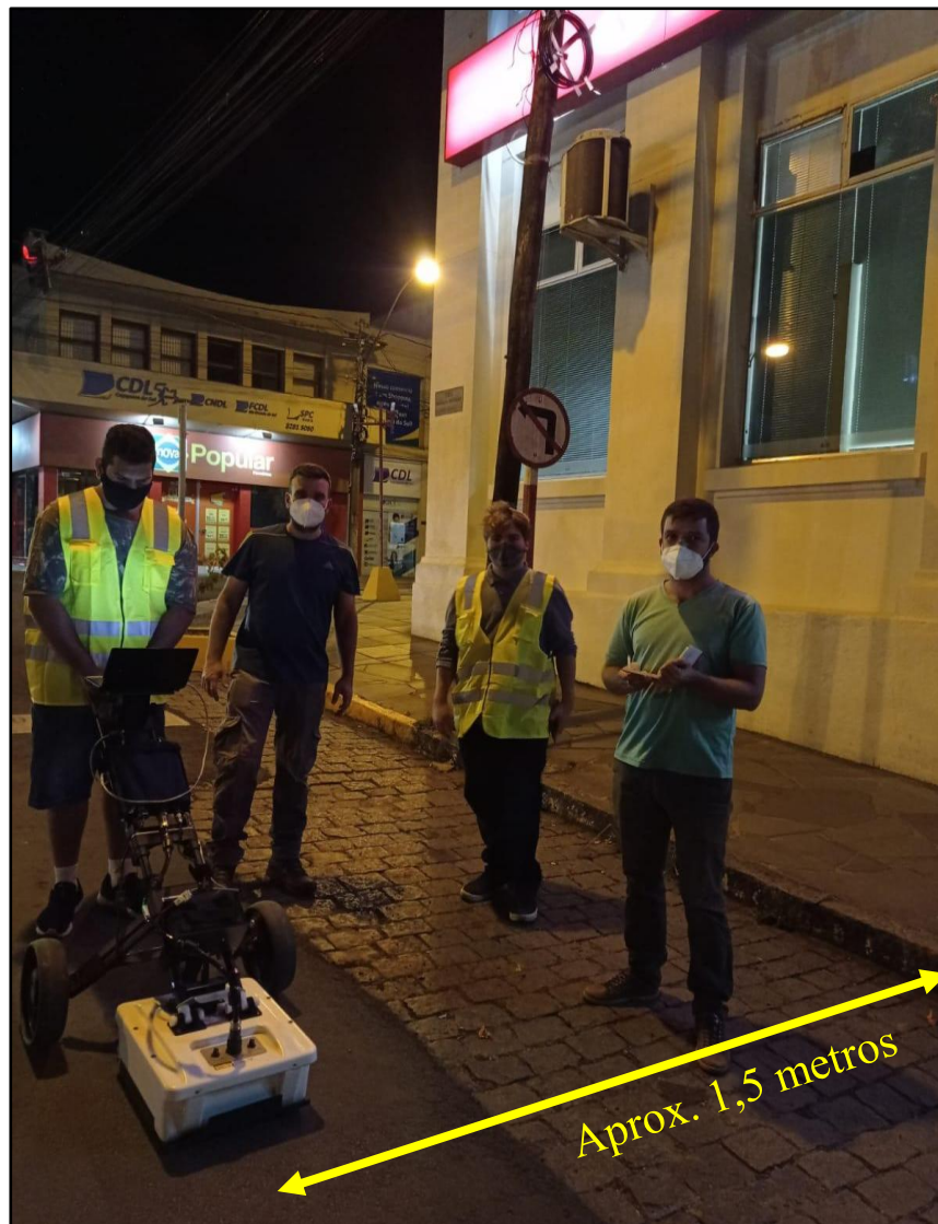
Figura 13 - Aquisições dos dados de GPR com antena de 200 MHz
