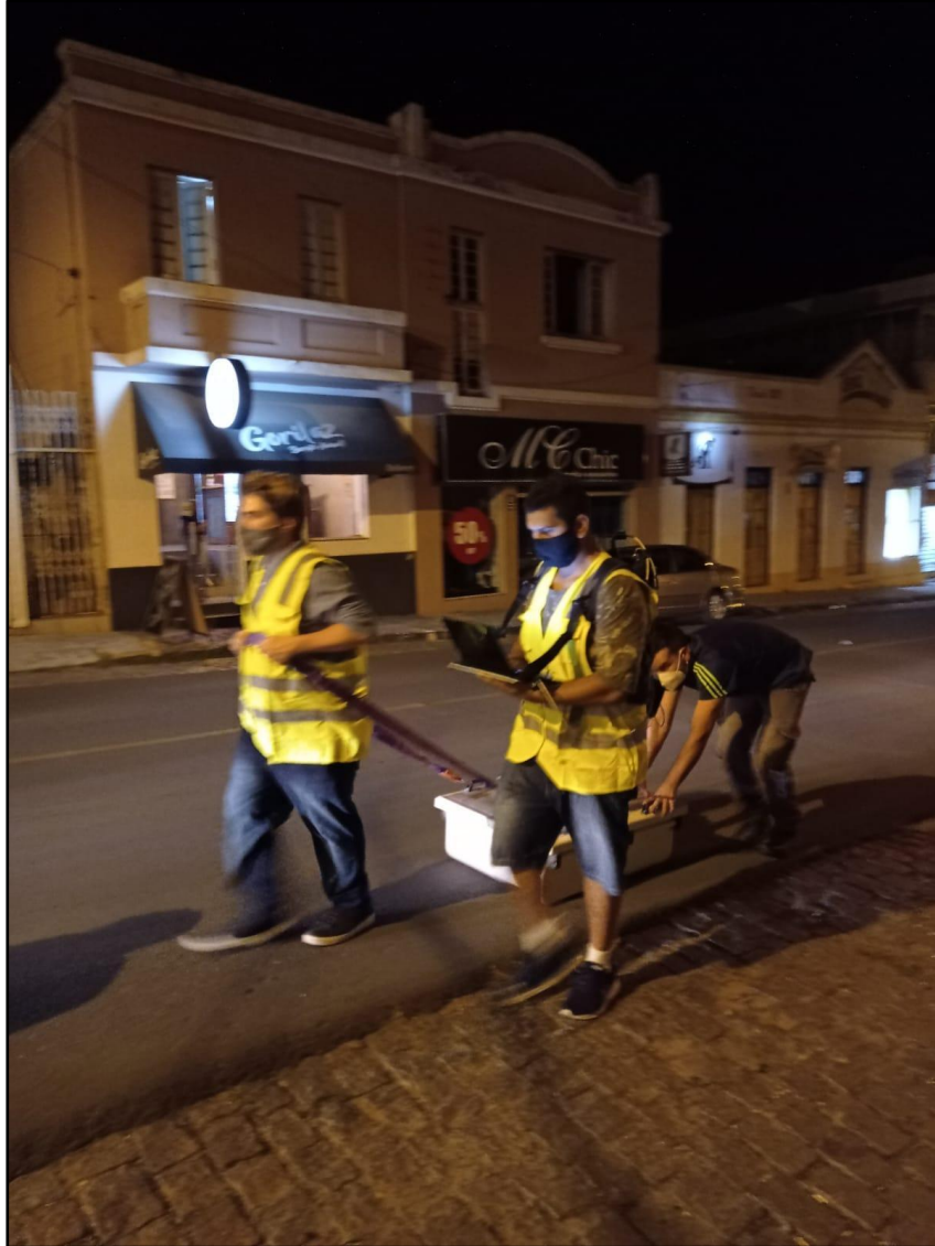
Figura 12 - Aquisições dos dados de GPR com antena de 80 MHz
