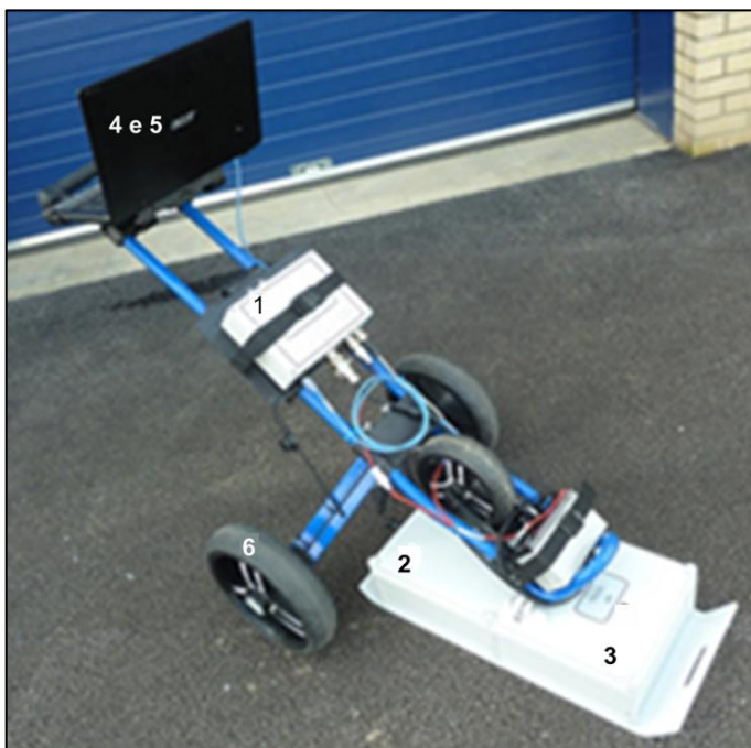
Figura 7 - Elementos básicos de um sistema GPR: (1) Unidade de controle; (2) Antena transmissora; (3) Antena receptora; (4 e 5) Unidade de exibição/monitoramento; (6) Odômetro
