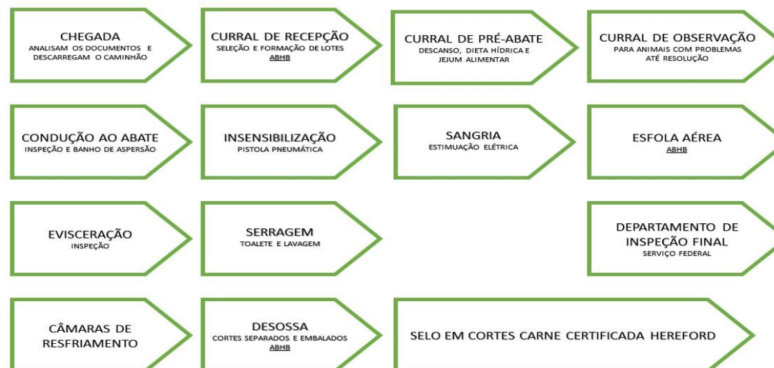
Figura 4 – Fluxograma do processo industrial.
