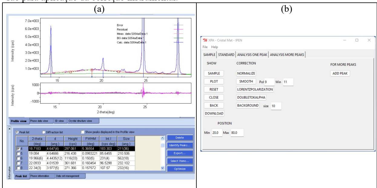
Figura 3.4 – Interface dos programas: (a) PDXL (@Rigaku) e (b) XPA. As abas da interface são para carregar os arquivos dos difratogramas da amostra e do material padrão. Os botões são para aplicação da correção instrumental.
