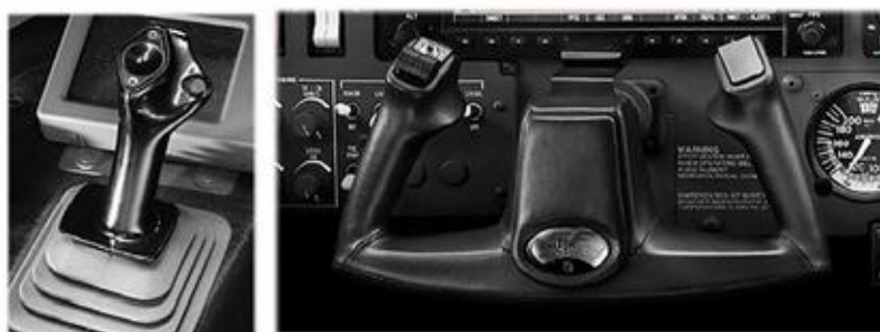
sidestick e o manche convencional, responsáveis pelo controle dos ailerons e profundor
