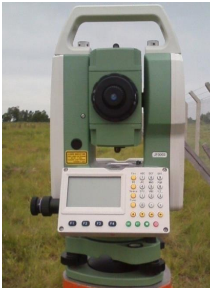
Figura 3 - Estação total na posição inversa
