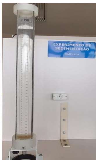
Figura 2 – Módulo de experimento de sedimentação
