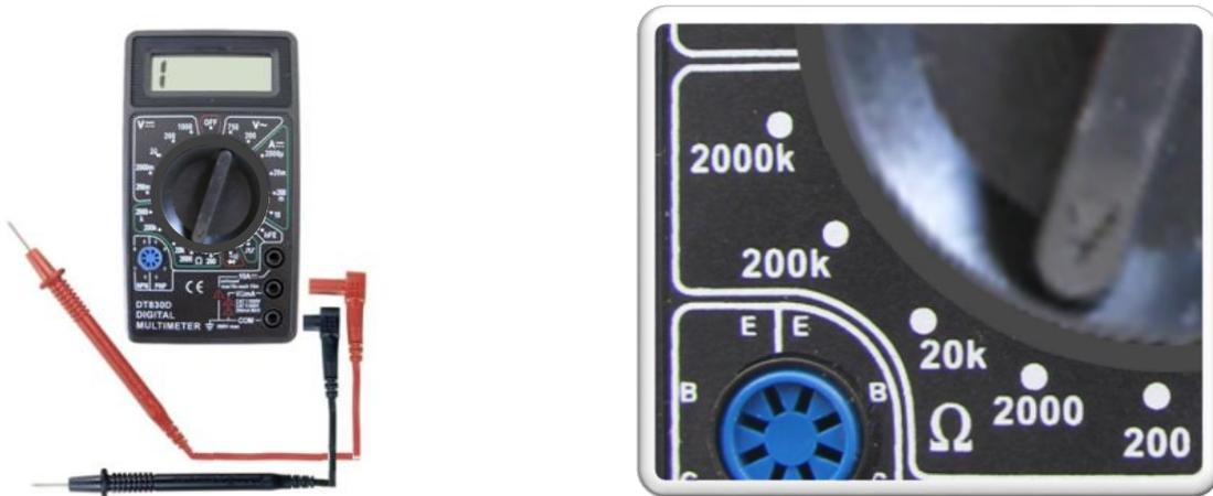
Figura 4 – Multímetro na função resistência em fundo de escala 2000.
