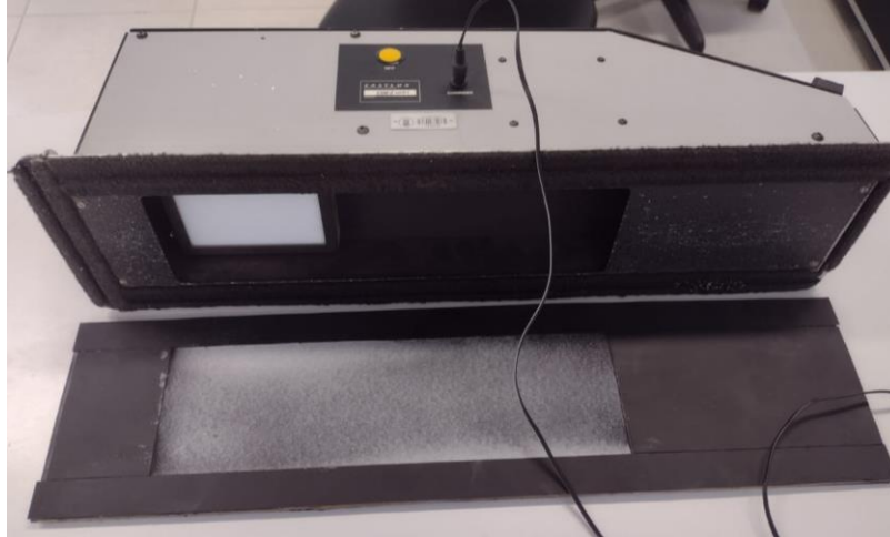
Figura 37 - Retrorrefletômetro e placa de medição durante a avaliação da retrorrefletividade.
