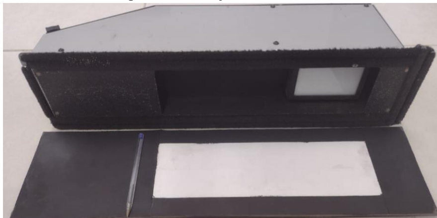
Figura 35 - Retrorrefletômetro e placa de medição.
