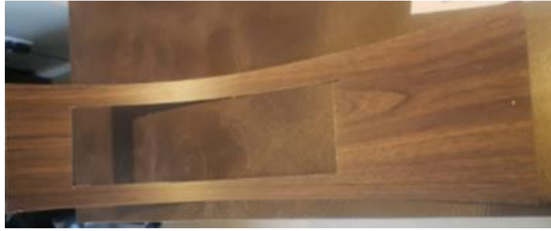
Figura 34 - Placa de fórmica com a abertura da área de medida.
