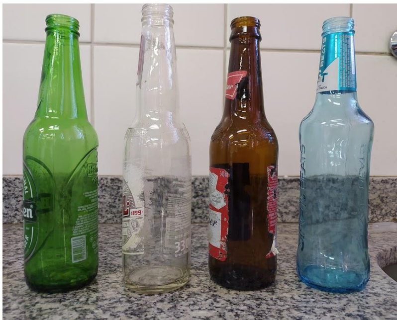
Figura 11 - Garrafas utilizadas na produção das microesferas.
