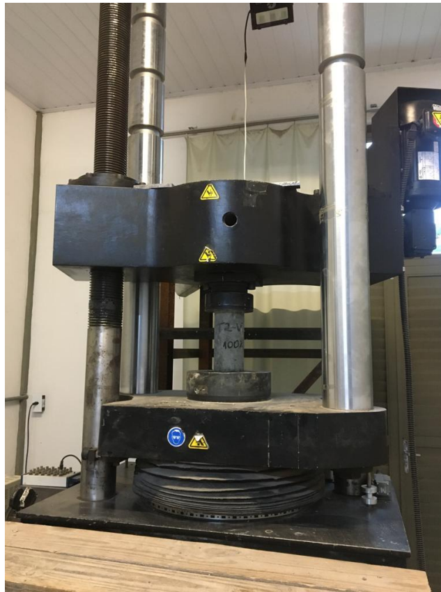
Figura 13 – Ensaio de resistência à compressão em 100% do carregamento do traço com vidro
