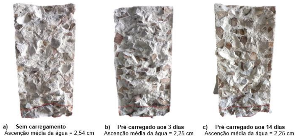
Figura 14 – Ascensão da água para o concreto com aditivo cristalizante - X - após o ensaio de absorção na idade de 76 dias
