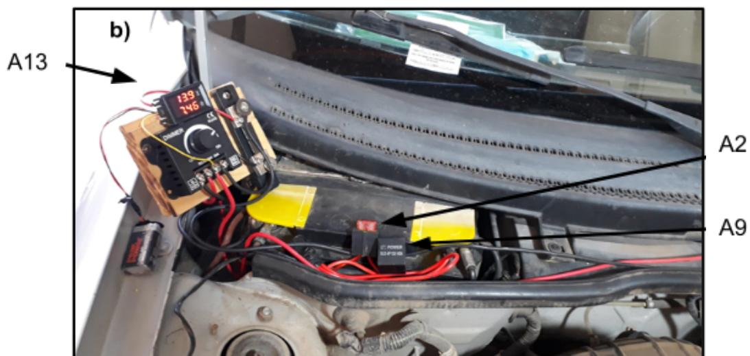
Finalmente, como es ilustrado en la *figura 37c*, se visualiza la conexión tanto del terminal positivo como negativo, que viene luego del accesorio A13.
