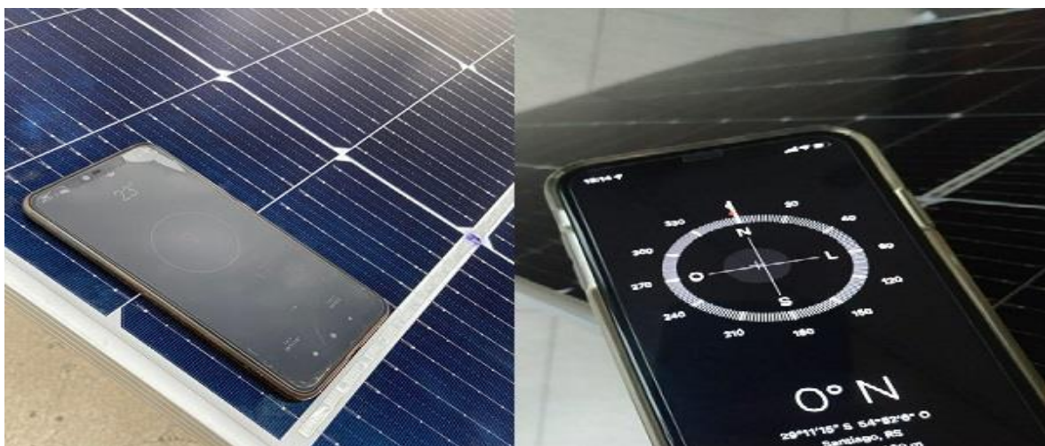
Figura 21 - Inclinação e Orientação Geográfica dos Módulos Fixos.
