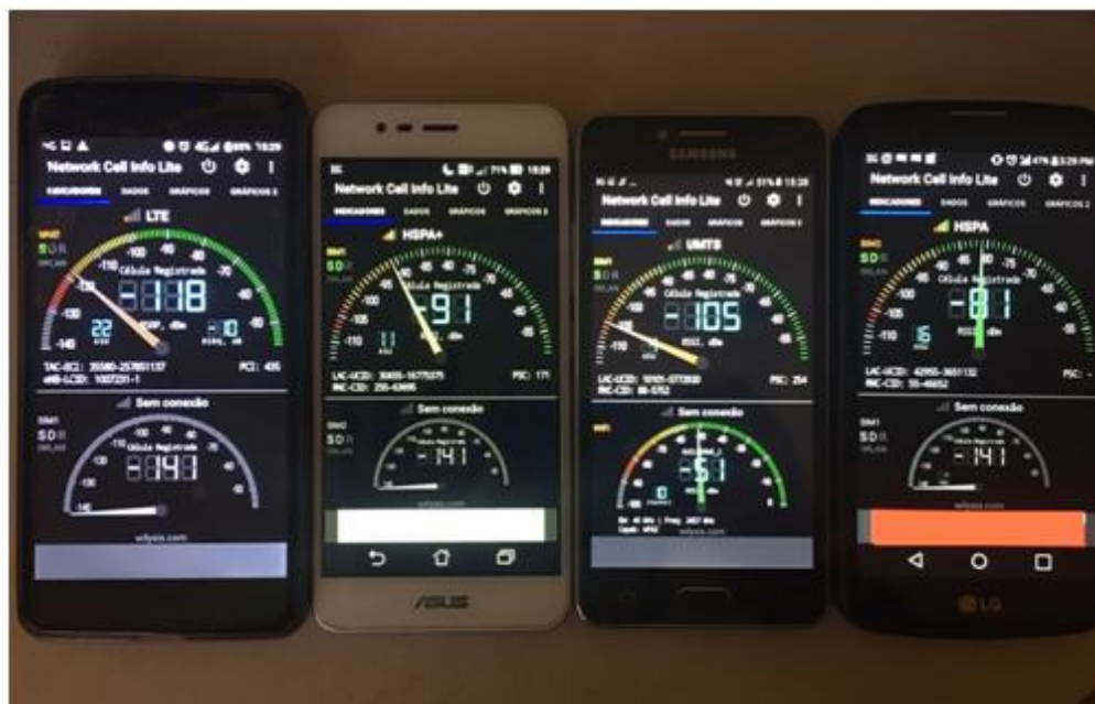
Figura 2 - Smartphones utilizados para a medição do sinal 4G, com o aplicativo de medição ativo.
