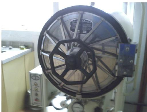
**Figura 1.** Autoclave do tipo horizontal equipamento utilizado para esterilização de utensílios e meio de cultura. Pelotas, Embrapa Clima Temperado, 2010.
