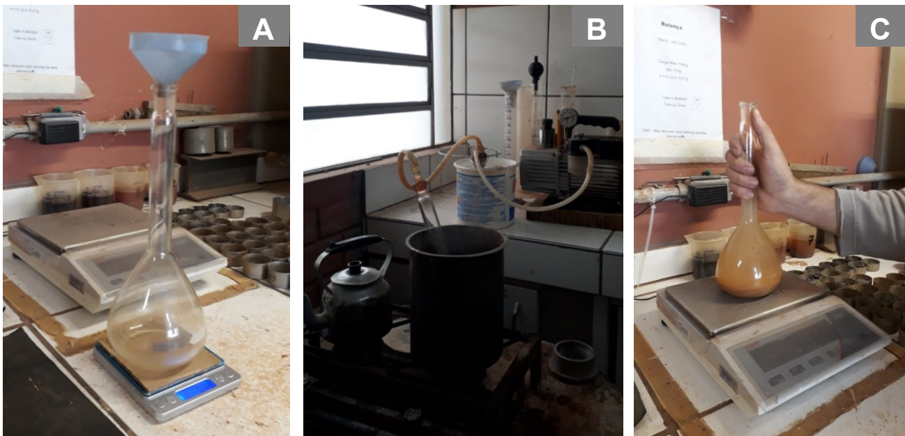
Figura 34. Figura 34.(A) Taragem do picnômetro e funil; (B) Material vinculado a bomba de vácuo (C) Pesagem do picnômetro com material.
