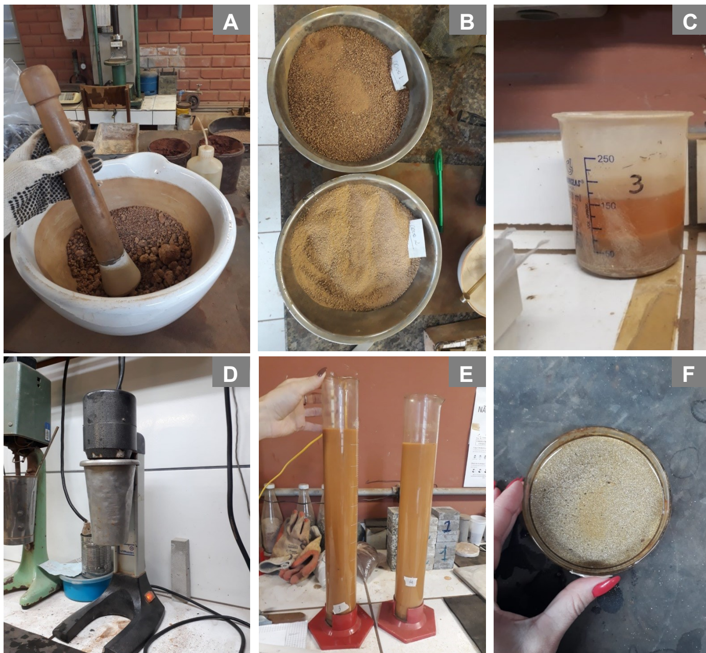
Figura 32. (A) Amostra sendo destorroada; (B) Material passante na peneira de 2mm; (C) Amostra em repouso com defloculante; (D) Instrumento difusor; (E) Material em proveta de vidro; (F) Material fino em placa petri.
