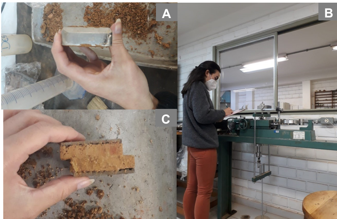
Figura 36. (A) Material cravado no anel; (B) Equipamento utilizado no ensaio de cisalhamento direto. (C) Amostra cisalhada após execução do ensaio.
