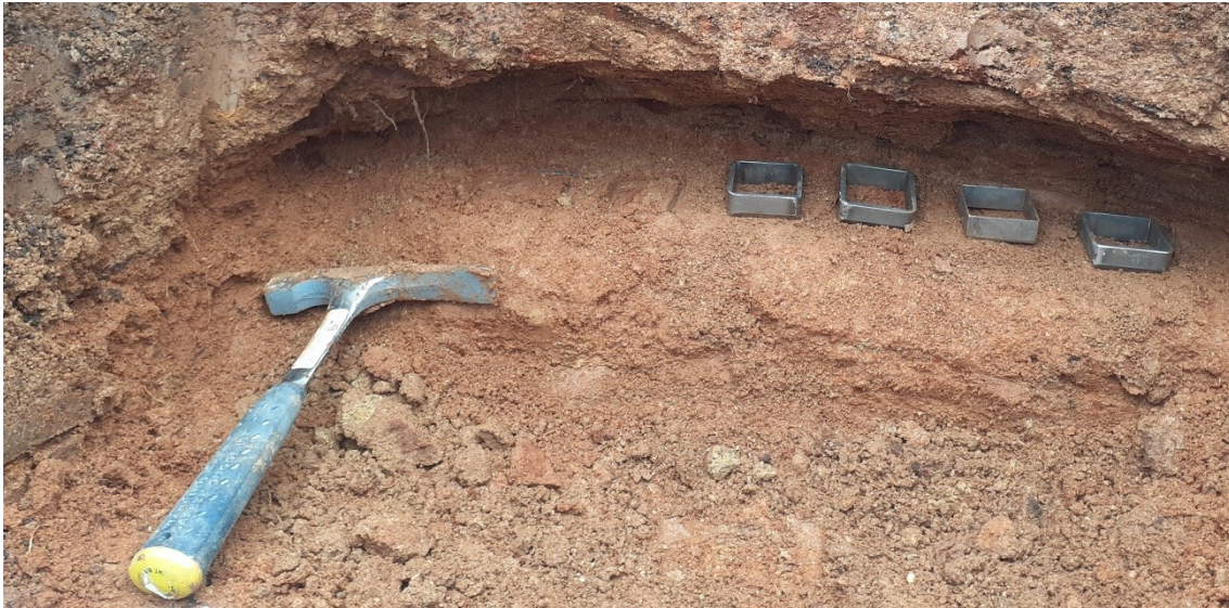
Figura 35. Registro da coleta do material indeformado através dos anéis de cisalhamento direto.
