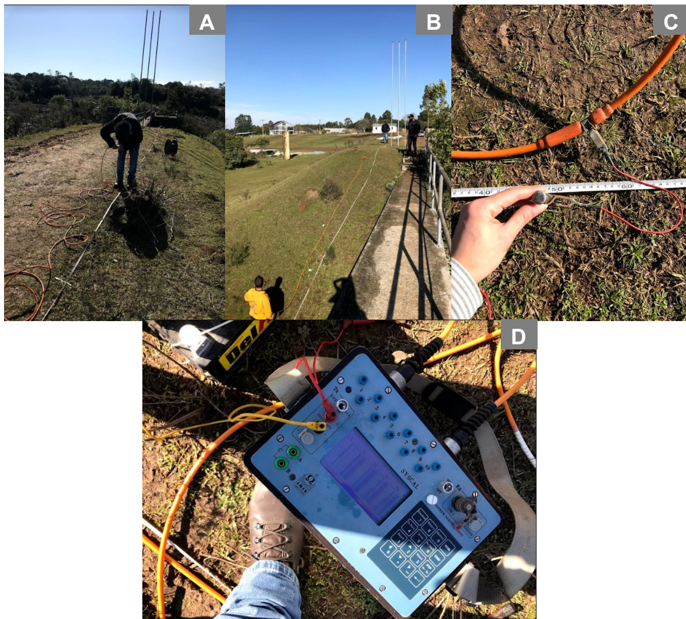
Figura 29. (A) Montagem dos equipamentos em campo (B) Visualização geral do levantamento geofísico (C) Conexão do eletrodo, bobina e jacarés; (D) Equipamento SYSCAL utilizado.
