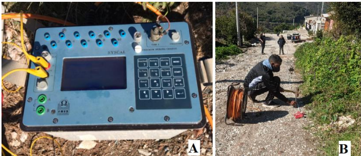
Figura 20 - Composição de imagens referente ao levantamento geofísico: A) Resistivímetro; B) Posicionamento dos eletrodos
