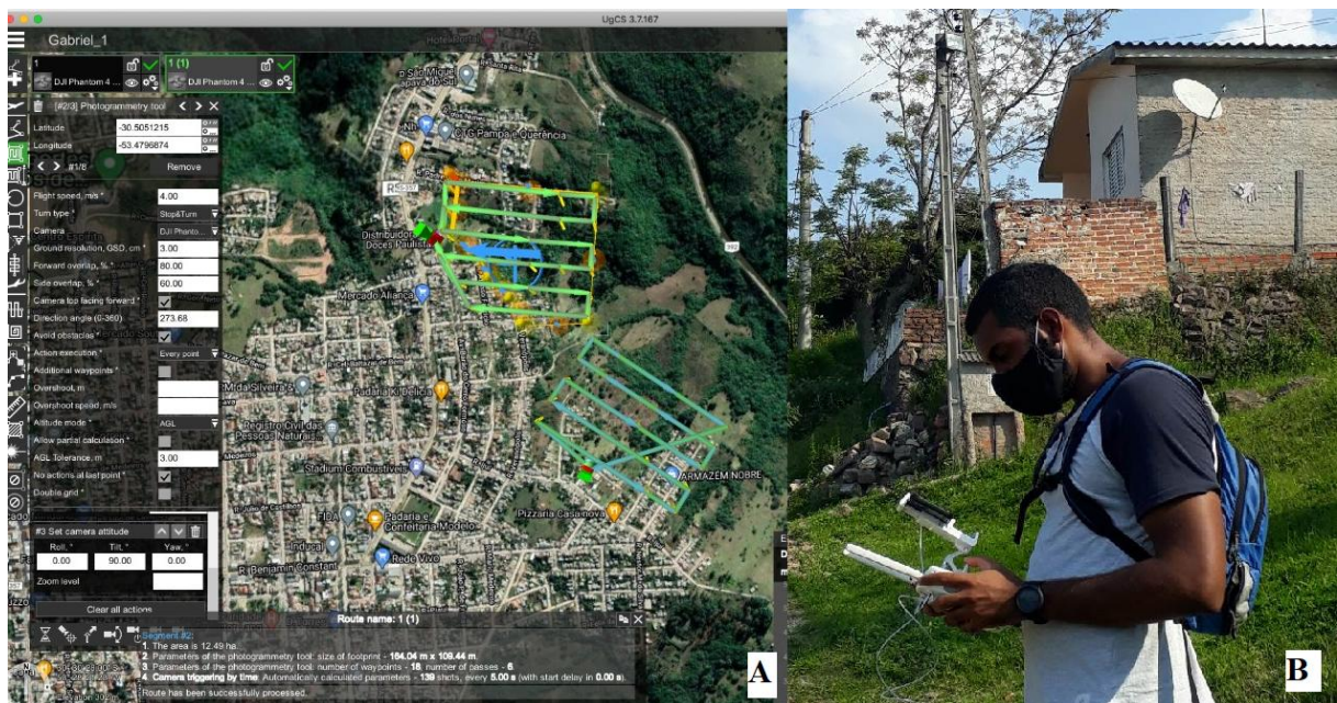
Figura 17 - Composição de imagens referente ao levantamento aéreo: A) planejamento prévio do voo; B) Execução do voo em campo
