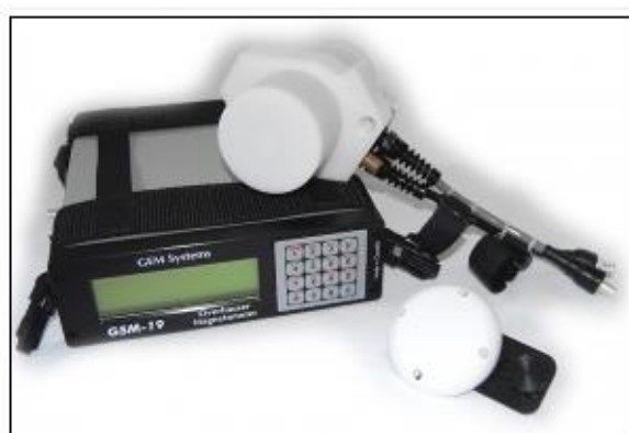
Figura 41 - Equipamento magnetômetro GEM Systems GSM-19
