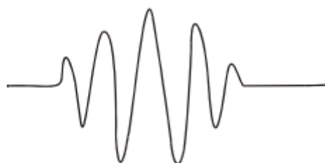
Figura 30 - Representação de um pulso eletromagnético emitido por aparelhos de GPR
